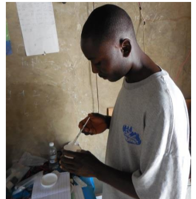
Das aufbereitete Hypochlorit wird mit der Testflüssigkeit geprüft, ob genügend Chlor pro Milliliter enthalten ist.
